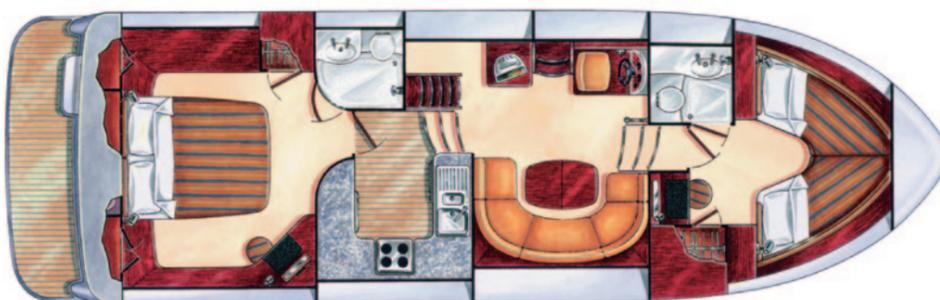
Länge: 12,95 Meter Breite: 3,84 Meter Tiefgang: 82 cm Maschine 65 PS
